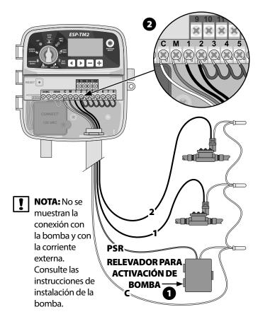
**NOTA:** El controlador ESP-TM2 NO suministra corriente para una bomba. El cableado del relevador debe seguir las instrucciones del fabricante.
