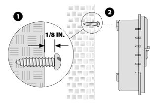
3 Remover la tapa de la caja de cables situada en la parte inferior de la unidad y pase un tornillo a través del agujero central, del modo indicado.
