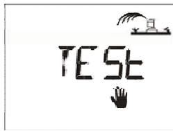
Esta función prueba todas las estaciones conectadas a su WP un ciclo de dos minutos y le permite comprobar el buen funcionamiento del riego.
