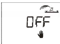
Por defecto, el programador se encuentra en modo "ON", con lo que el riego programado puede producirse. Sin embargo, existe la posibilidad de evitar el riego (desconexión durante períodos lluviosos) sin modificar los programas de riego:
