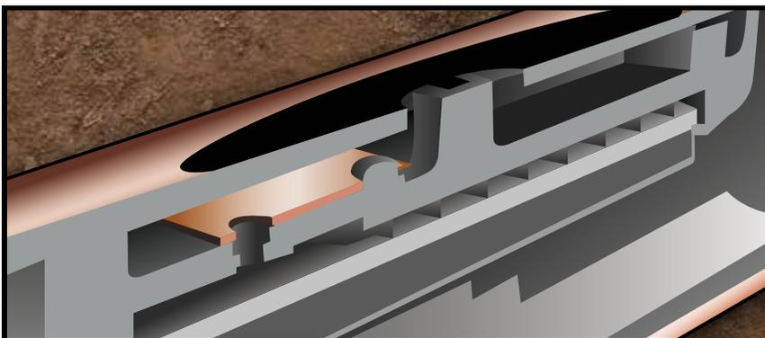
Los goteros XFS se protegen de la entrada de raíces con la tecnología Copper Shield de Rain Bird, con patente solicitada, logrando un sistema que no requiere mantenimiento o cambio de productos químicos para evitar la entrada de raíces. El color marrón exterior garantiza que el cobre está en su interior.
