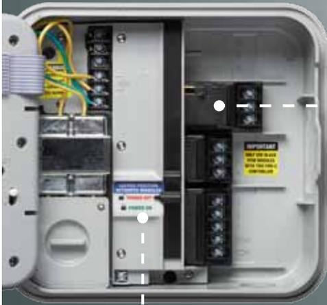
La unidad básica de 3 estaciones llega a ampliarse a 15 estaciones con los módulos PCM.
